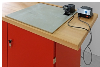
Support ignifugé pour les travaux électroniques (soudure)
