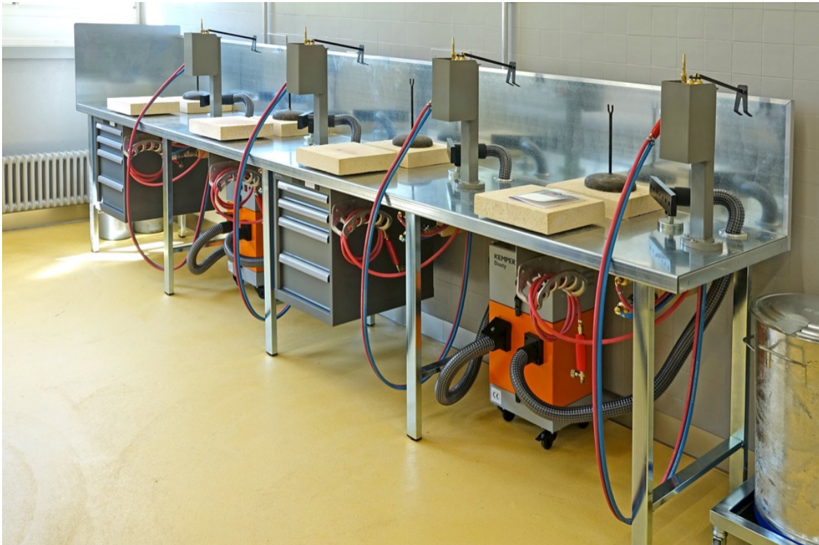
Schweisstation mit durchgehender Rückwand; komplett eingefasst mit rostfreiem Stahlblech
