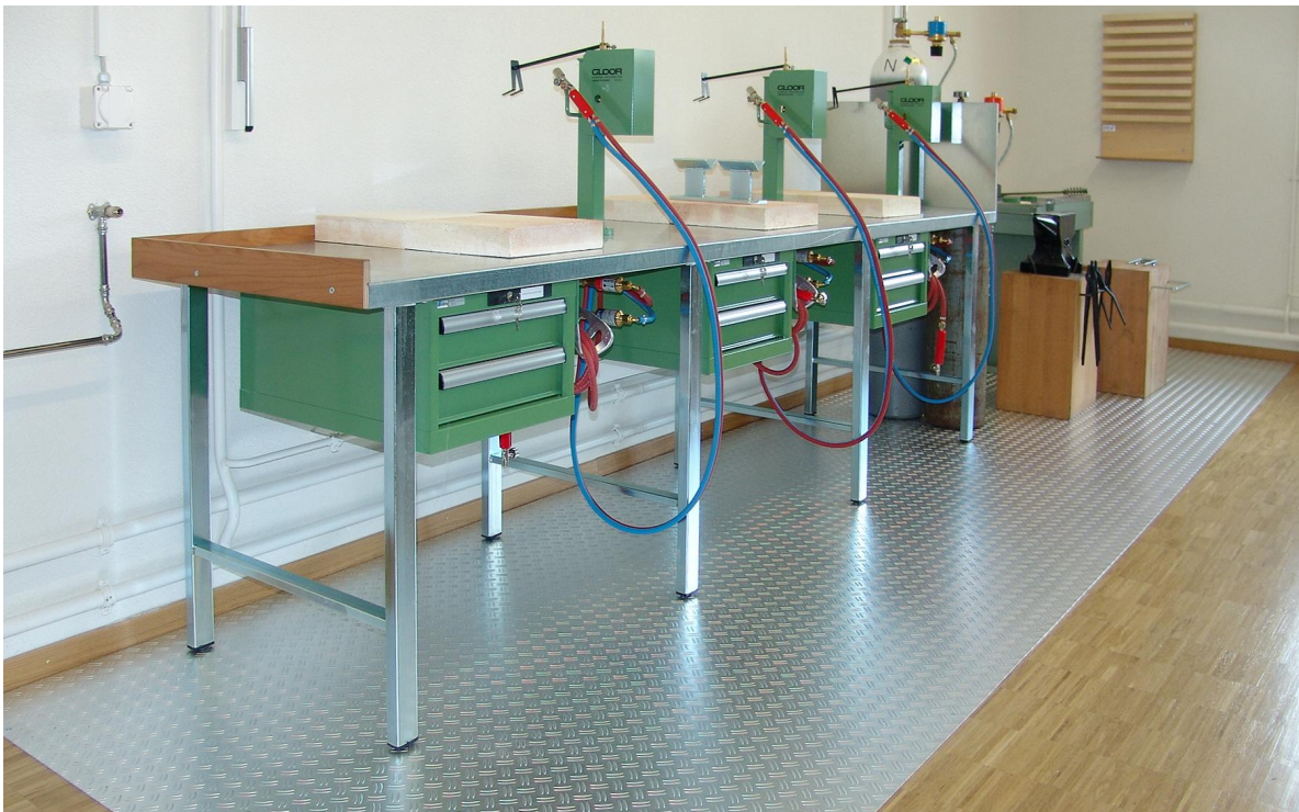
Riffel-Schutzblech am Boden, rechts Amboss mit Zangen
