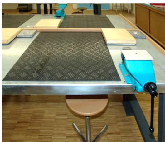
Eine zusätzliche Riffel-Gummimatte schützt die Arbeitsfläche vor mechanischen Beschädigungen
