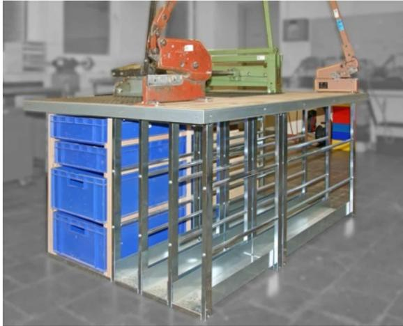
Kombi-Gestell für Langeware, Rundmaterial sowie Behälter für Handmaschinen und Zubehör: alles direkt am Arbeitsplatz und schnell zur Hand.
