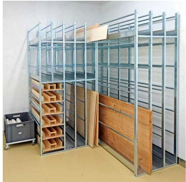
Ein Kombigestell für Platten, Rundholz und Längsmaterial bietet schnellen Zugriff und nutzt die Bodenfläche optimal aus.
