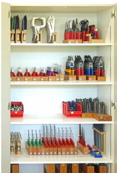
Regalböden haben gegenüber den Behältern den Vorteil, dass der gesamte Inhalt sofort sichtbar ist. Regalböden eignen sich für die Unterbringung der Werkzeugblöcke und für Sachen, die in keine Kiste passen.
